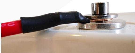
Figuur 4. FOUT! Losse verbinding door toepassing van te lang bout
